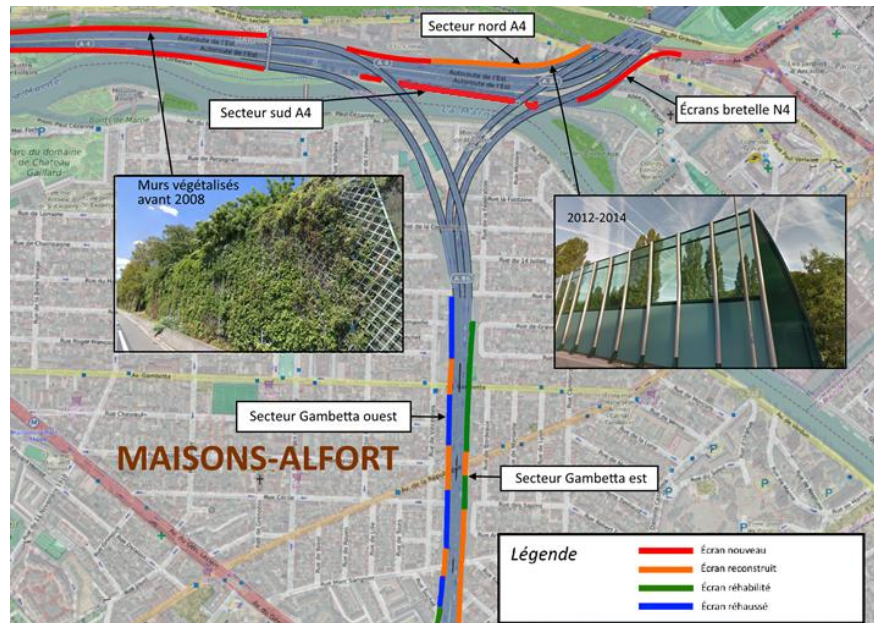
Ecrans réalisés sur le secteur nord de l'opération de protection acoustique sur les communes de Saint-Maurice, Maisons-Alfort et Créteil
